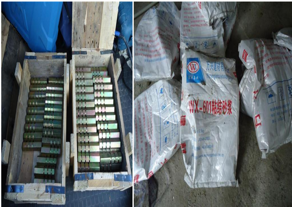
建筑物隐蔽式沉降观测标及粘结砂浆
